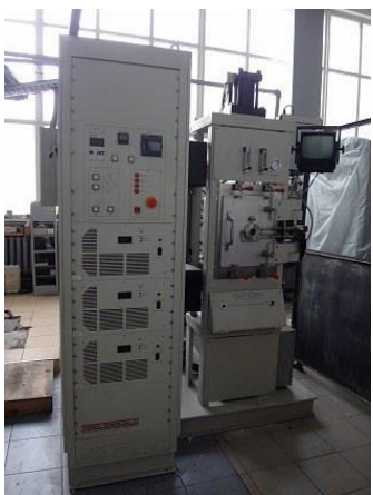
Рисунок – 1. Оборудование SPS 10-3 для проведения диффузионной сварки в вакуум ( 10^{-4} торр).
