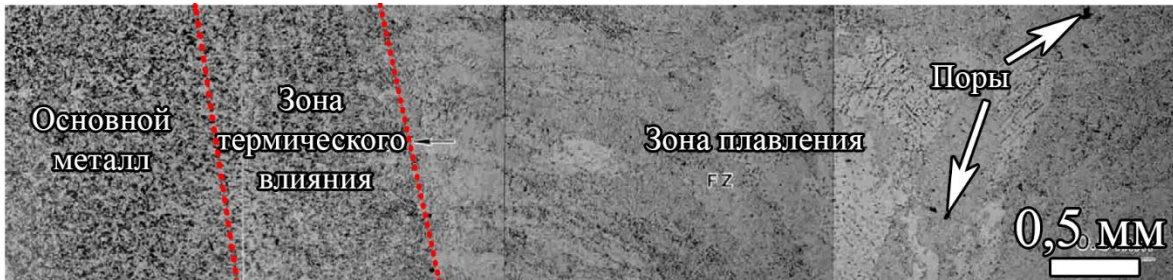
Рисунок – 2. На фото показан образец, сваренный АДС поперек направления прокатки. Направление прокатки горизонтальное*
