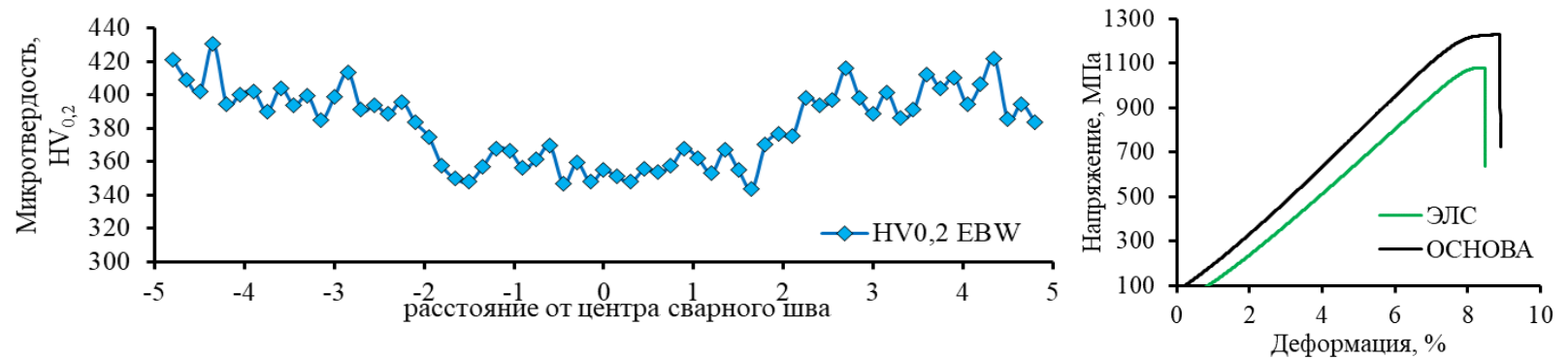
Рисунок – 4. Микротвердость в поперечном сечении и механические свойства сварного соединения из сплава ВТИ-4, полученного электронно-лучевой сваркой (ЭЛС) и основного материала
